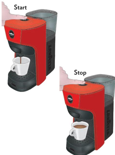
**!** Si mientras se dispensa se agota el agua del depósito, la máquina **NO** se detiene.
