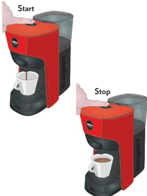
**!** Se durante o fornecimento a água dentro do reservatório termina, a máquina NÃO se desactiva. Certifique-se que o reservatório esteja sempre cheio antes de iniciar o fornecimento.
