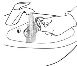
6. Inserire il filtro dell'acqua e riposizionare lo zoccolo: reintrodurre il filtro dell'acqua ruotandolo in senso orario. Assicurarsi di ruotarlo fino in fondo: la manopola del filtro deve trovarsi in posizione verticale. Per verificare la tenuta del filtro dell'acqua, versare circa un litro d'acqua nel dosatore del detersivo. Riposizionare lo zoccolo.
