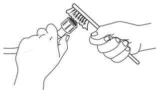
3. Svitare quindi manualmente il tubo di carico sul retro della lavatrice. Estrarre con le pinze il filtro a rete dalla valvola nella parte posteriore della lavatrice e pulirlo accuratamente.
