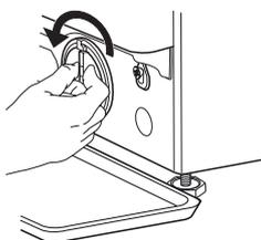
4. Rimozione del filtro: posizionare uno straccio di cotone sotto il filtro dell'acqua affinché assorba l'acqua residua. Estrarre il filtro dell'acqua ruotandolo in senso antiorario.
