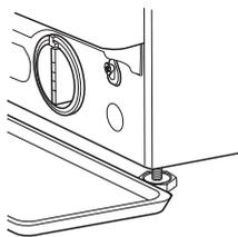
3. Scaricare l'acqua: ruotare lentamente il filtro in senso antiorario finché non fuoriesce tutta l'acqua. Far defluire l'acqua verso l'esterno senza rimuovere il filtro. Una volta riempito il contenitore, chiudere il filtro dell'acqua ruotandolo in senso orario. Svuotare il contenitore. Ripetere la procedura fino a quando tutta l'acqua è stata scaricata.
